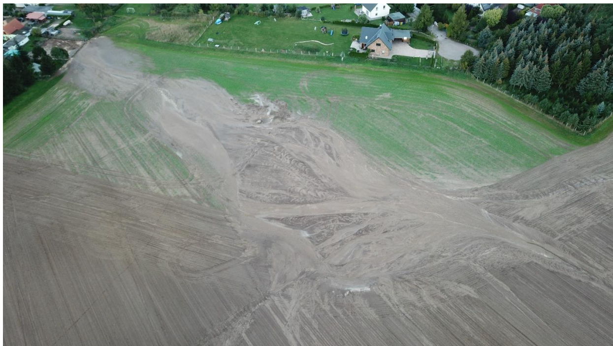
Abbildung 3-57: Starkregen am 17.09.2022 in Bröbberow (Mittleres Mecklenburg) und aufgetretener Landoberflächenfluss mit starken Bodenerosionserscheinungen
